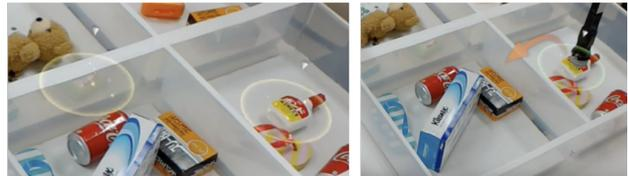
図 4 AR による曖昧物体の提示. 左図: 曖昧性の提示 (緑色と白色のボンドの曖昧性を表現). 右図: 目標物体 (白色のボンド) と移動先の提示.
